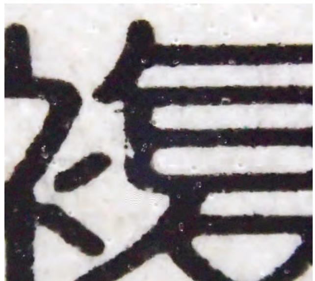
一刀切割出來的網點邊際，是德國 Miller 米勒平印機所印，印版可能是多層金屬版，表層鍍鉻，下面以紫銅產生印紋的方式。而無水平版印刷的網點再現性，也十分接近這一種很高級版材所印精準印紋效果，一般有水平版印刷，以 200 線，每邊多 3 $\mu$  算很好了，多到 5 $\mu$  或 7 $\mu$  也常有發現，毛邊網點不結實，仍有水平的常態，在另一方面乳化墨中水暗部層次不好，網態，但只能視而不見敷衍下去。尤其高百分比 IPA 酒精濕潤系統為然。連文字字邊也有 5 $\mu$
